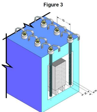
X = distance entre l'axe de la résistance et une surface rayonnante (par ex. brique réfractaire ou produit à chauffer)
