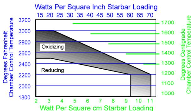
Il y a un film protecteur de dioxyde de silicium sur nos résistances Starbars®. L'hydrogène est susceptible de réduire ce film protecteur et peut causer des dégâts sur les résistances en Carbone de silicium, particulièrement en présence d'hydrogène très sec ou très humide.
